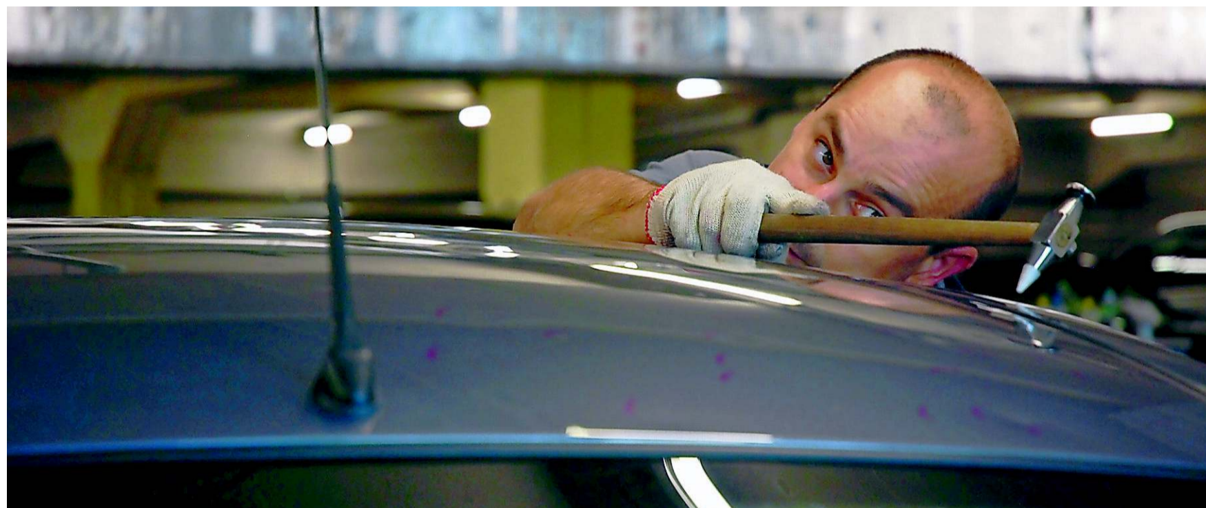
Mit eindrücklichen Werkzeugen und äusserster Präzision schlagen die Dellendrucker die Hagelbeulen aus dem Metall.
